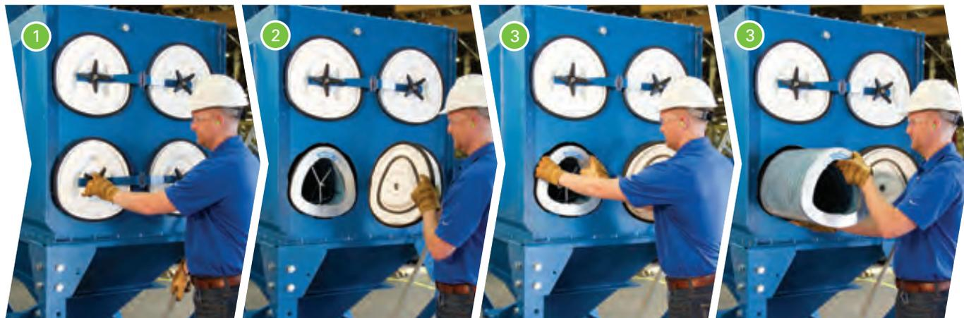
**1** Aflojar la cubierta con la perilla de 4 lóbulos. La perilla tiene una oreja central que posibilita la operación de la herramienta eléctrica.
